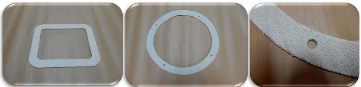
耐熱纖維を製織した織布に天然ゴムを塗布し、所定の平面形状に仕上げたガスケットです。
